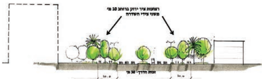
▲ ציר ירוק קרית שלום-יפו העתיקה. חתך טיפוסי שדרות בן צבי. רם אייזנברג אדריכלות נוף
